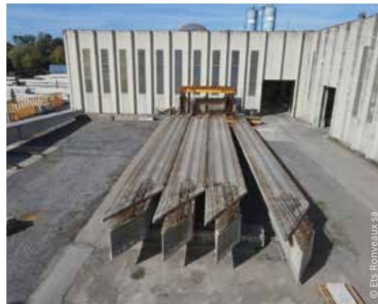
Omdat de landhoofden van deze constructie niet loodrecht op de assen van de liggers staan, was het nodig om aanzienlijke schuine vlakken te maken aan elk uiteinde van de liggers.
