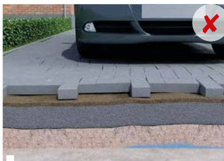
Oneffen terrassen of opritten zijn deels te wijten aan een onstabiele ondergrond.
